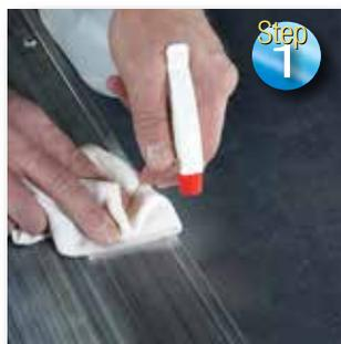
**Pulire** la superficie con una soluzione di alcool isopropilico e acqua (50:50) e asciugare. Si consiglia l'utilizzo di un primer dopo la pulizia per massimizzare le performance.
