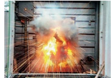
Il cortocircuito genera una corrente di 11 kA diffondendo gas e rame fuso ad alta velocità.
